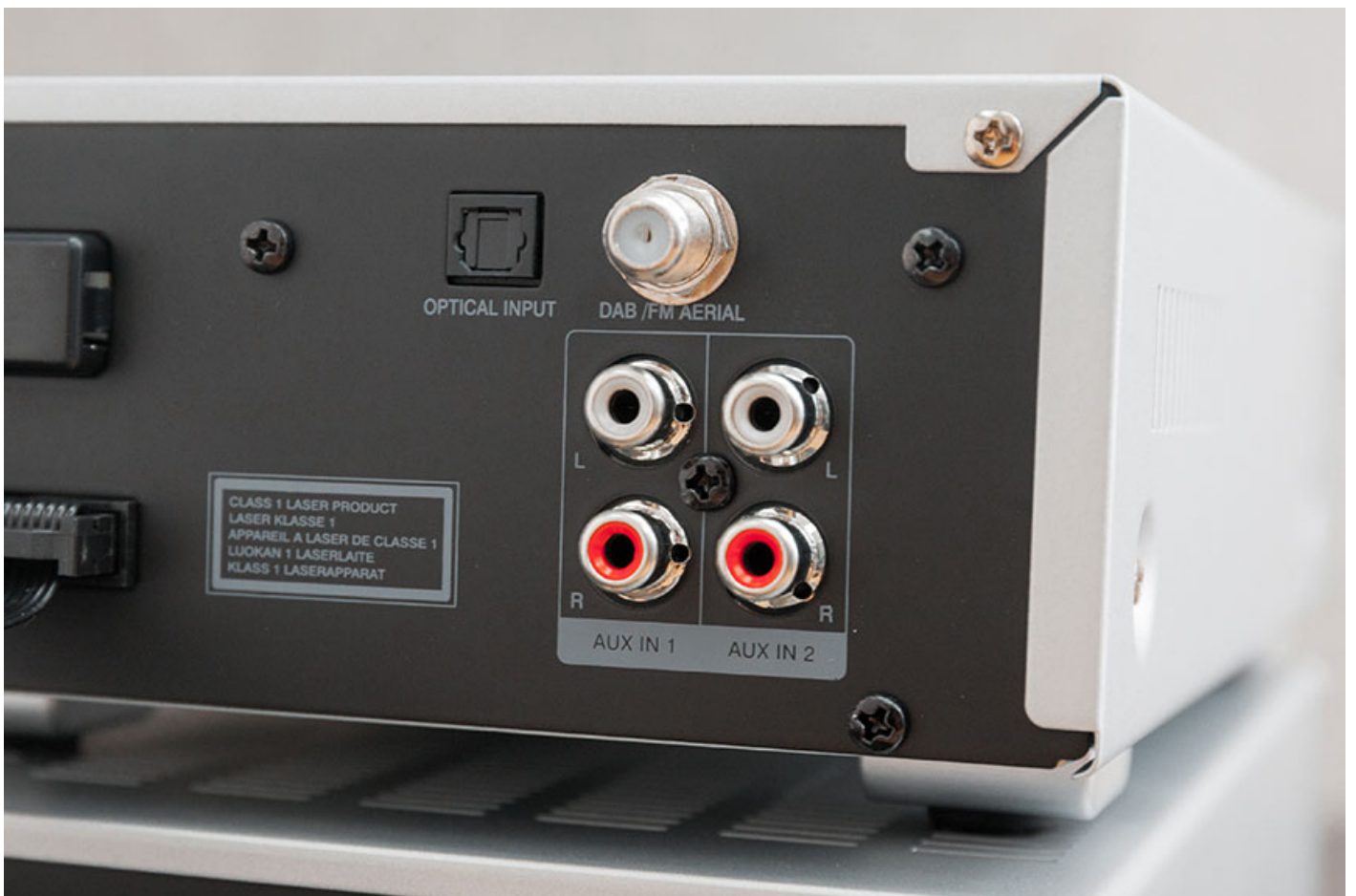
支援 RCA、光纖輸入，接駁電視或者其他訊源都可以，另外亦支援收聽 FM、DAB+ 電台。
