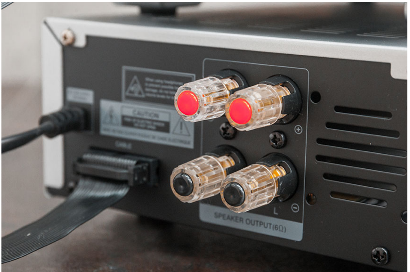
喇叭端子則是蕉插設計，每聲道提供 45W 輸出，日後想自己配過對喇叭使用都方便。
